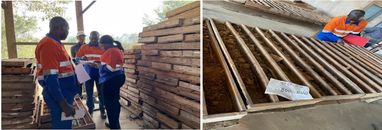
Photo 4 : Identification des caisses à carottes des forages réalisés sur le permis Ni-Co.
